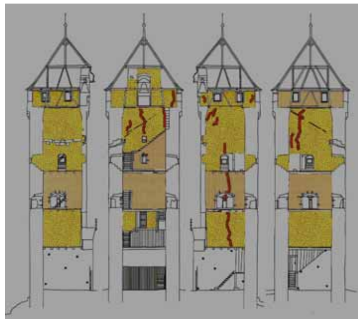
Zytturm mit Angaben der Schäden und Materialien Abbildung Expert Center, ETH Zürich
