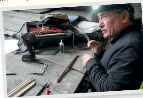
Der Dendrochronologe Raymond Kontic an der Arbeit. Vor ihm liegt ein Bohrkern, den er mit einem Hohlbohrer aus einem Bodenbalken des Luegislandturms entnommen hat.
